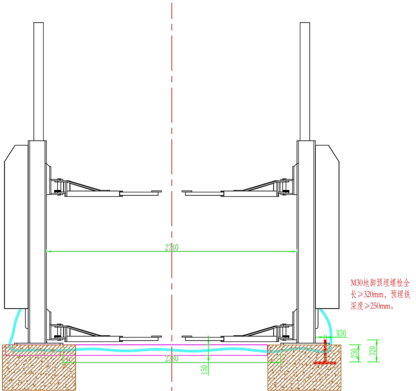
地面开槽深度150mm,宽度150mm,中心与两双柱升降机中心距离180mm。
