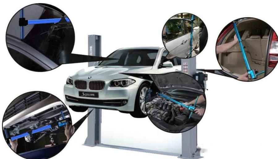
1. IntelliBT 电子测量主尺与电脑间的蓝牙通讯实时同步。
